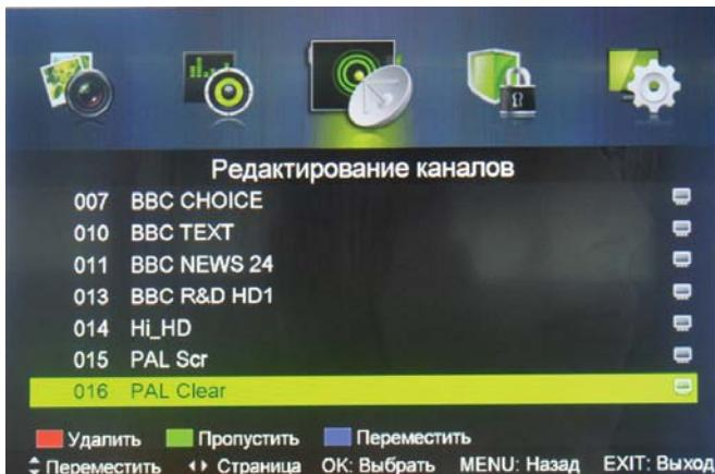
Три цветных клавиши предназначены для программирования каналов.
