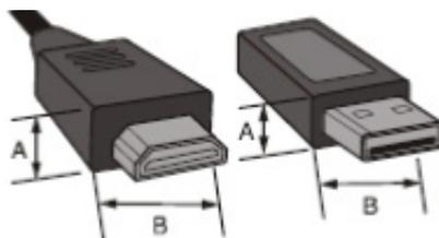
Размер входного разъема HDMI кабеля не должен превышать 10 мм (A) x 20 мм (B).
