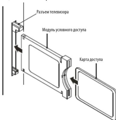
Вставьте карту доступа в модуль условного доступа в соответствии с инструкциями поставщика услуг. Затем вставьте модуль условного доступа в соответствующий разъем телевизора. Если вы чувствуете сопротивление при попытке вставить модуль, попробуйте вставлять его другой стороной.
