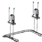
Соберите подставку, надежно закрепив ножки на основании с помощью четырех серебристых винтов.
