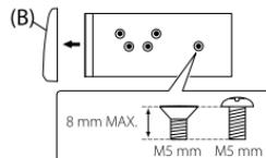
⚠ Usare soltanto le viti specificate. L'uso di viti diverse può causare il danneggiamento dell'unità.
