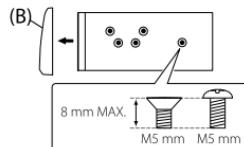
⚠ Verwenden Sie nur die vorgeschriebenen Schrauben. Durch Verwendung falscher Schrauben kann das Gerät beschädigt werden.
