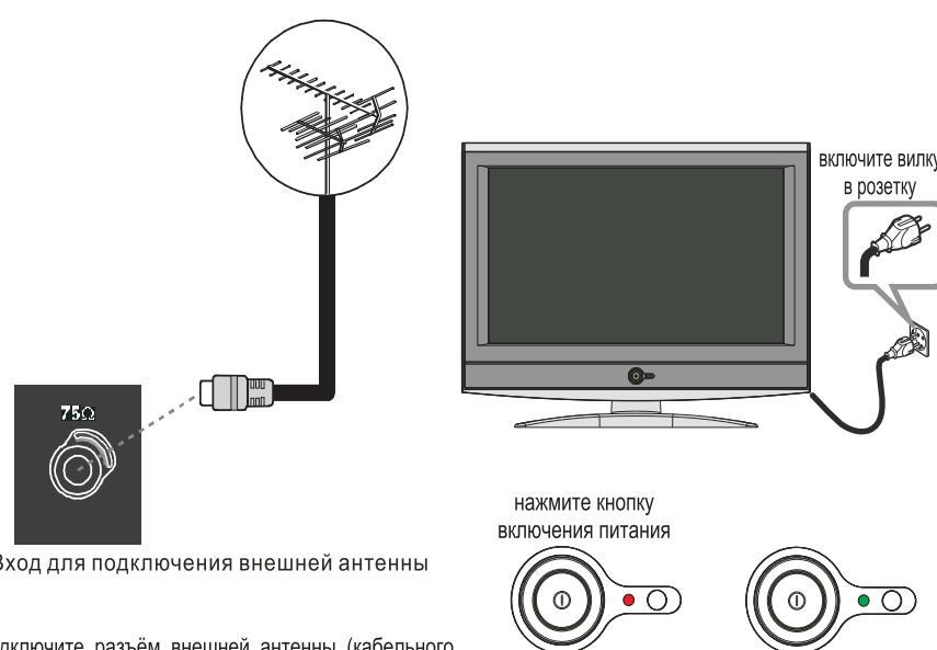
Подключите разъём внешней антенны (кабельного телевидения) в соответствии с выше приведённой схемой.
