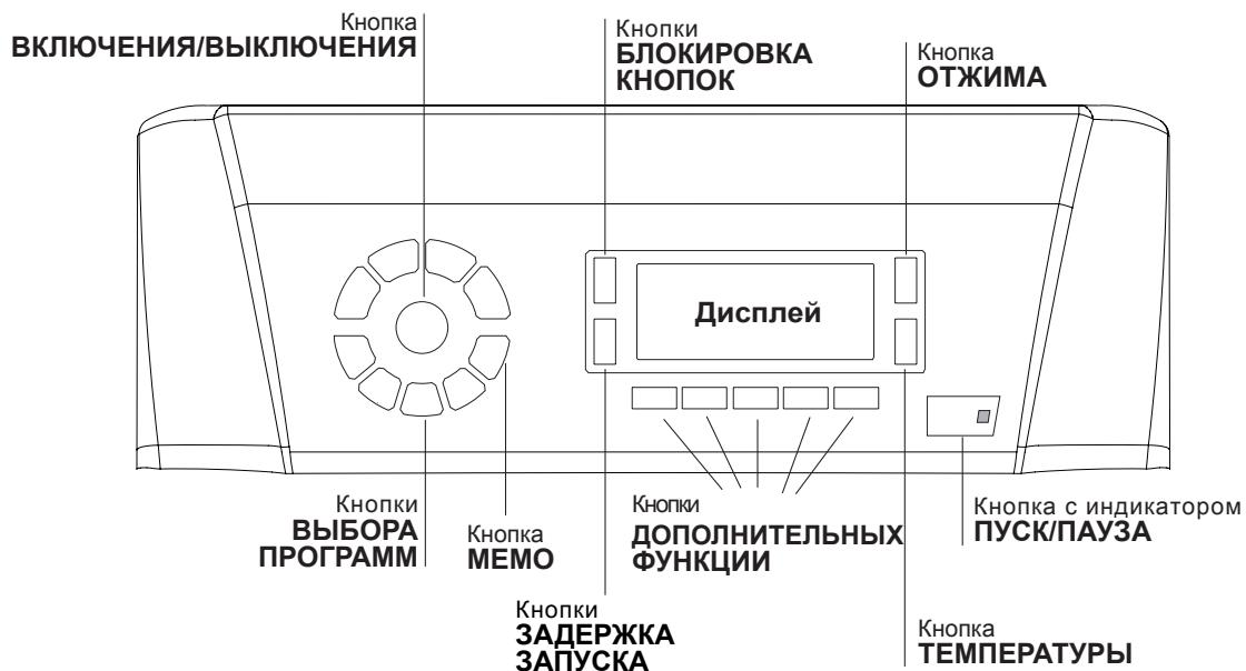
Кнопка **ВКЛЮЧЕНИЕ/ВЫКЛЮЧЕНИЕ** : быстро нажмите эту кнопку для включения или выключения машины. Индикатор ПУСК/ПАУЗА, редко мигающий зеленым цветом, означает, что машина включена. Для выключения стиральной машины в процессе стирки необходимо держать нажатой кнопку, примерно 2 секунды. Короткое или случайное нажатие не приведет к отключению машины. В случае выключения машины в процессе стирки текущий цикл отменяется.
