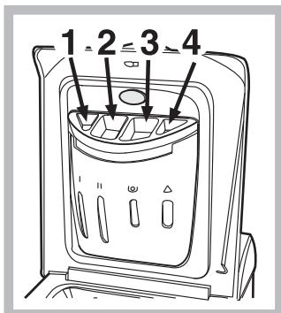
Выдвиньте распределитель и заполните его отделения моющим средством и смягчителем:
