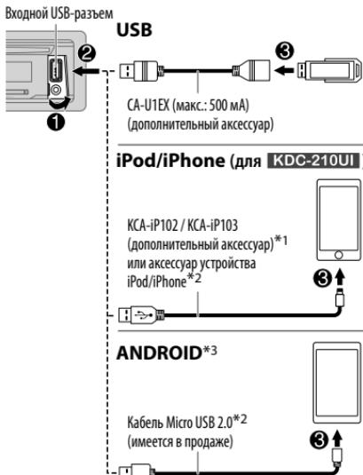
\*1 KCA-iP102 : 30-контактного типа, KCA-iP103 : Типа Lightning
