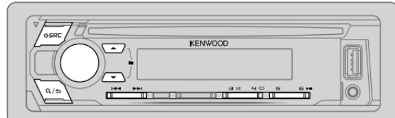
Для **KDC-210UI** : Чтобы напрямую выбрать источник USB/iPod/ANDROID, нажмите **iPod USB**.
