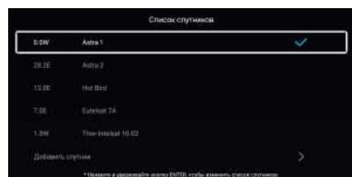
**Настройка спутника:** Используйте **▲/▼** для выбора подменю, далее нажмите **OK** для входа в настройки. Если выбран тип коммутатора универсальный, то в этом меню вы можете установить частоту спутниковой LNB антенны, транспондер, опцию 22кГц, Tone Burst (мини DiSEqC), питание LNB антенны; отобразить мощность (уровень) и качество сигнала. В
